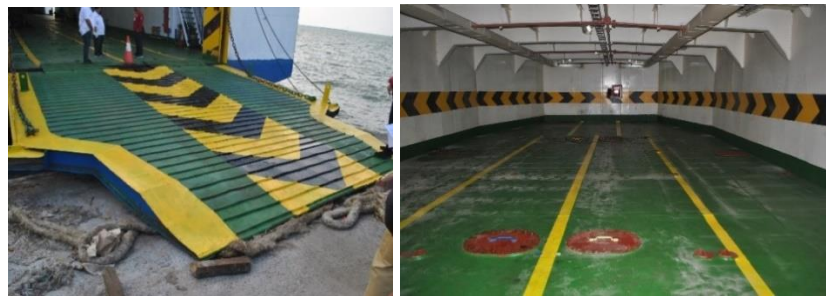
Gambar 5.22 Marka pada lantai geladak dan pintu rampa yang diharapkan
