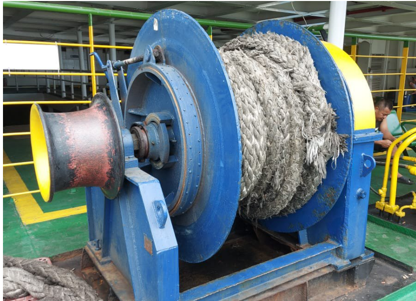
Gambar 4. 2 Winch dan Capstan Buritan di KMP. Portlink V
