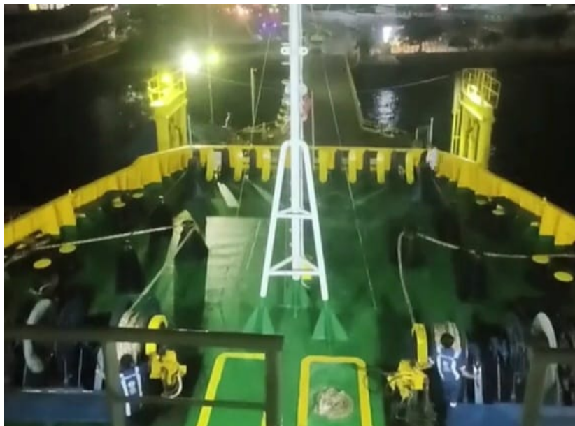
Gambar 4. 4 Kondisi Penerangan di Area Mooring KMP. Portlink V
