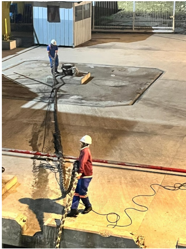
Gambar 2. 2 Proses Memasangkan Tali Tambat Di Bolder Dermaga 2 Merak
