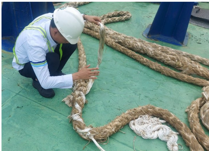
Gambar 4. 3 Kelasi Memeriksa Kondisi Tali Sebelum Mooring Operation
