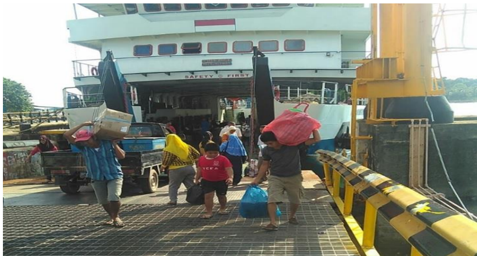
Gambar 1.2 Tidak Adanya Fasilitas Gangway Bagi Penumpang Pejalan Kaki
