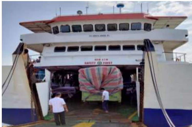
Gambar 3.2 Akibat Tidak Adanya Jembatan Timbang dan Portal
