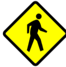
Gambar 2. 3 Rambu Peringatan Banyak Lalu Lintas Pejalan Kaki
