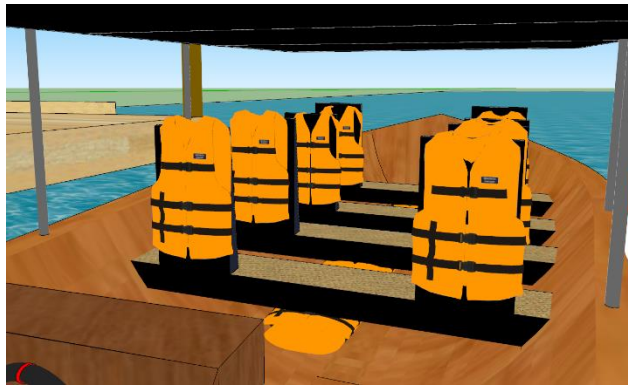
Gambar 5.3 Penempatan Life Jacket Pada Kapal Getek
