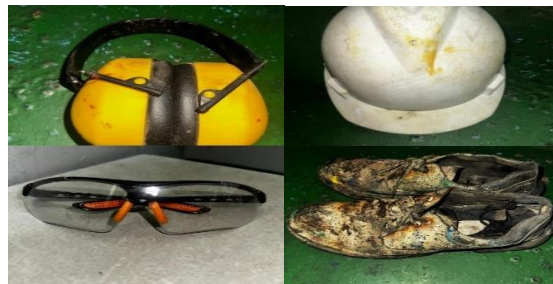
Gambar 4. 2 Alat Pelindung Diri(APD) yang tidak layak pakai
