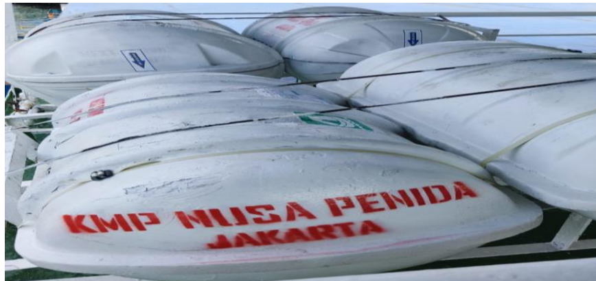
Gambar 5. 4 Kondisi Eksisting Liferaft pada KMP.Nusa Penida
