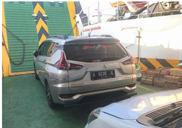
Gambar 1.2 Kendaraan di bagian haluan yang tidak diikat
