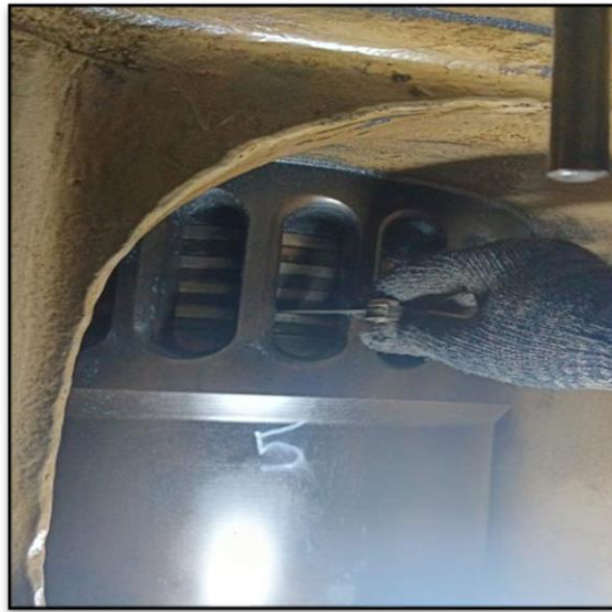
Gambar 4.4 Pengukuran gap ring piston
