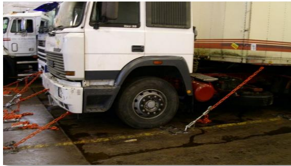
Gambar 5.14 Pengikatan Kendaraan 30 – 40 Ton
