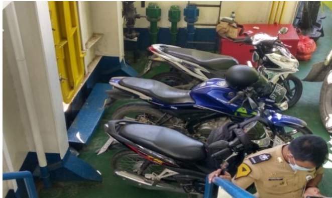
Gambar 5.5 Penempatan Kendaraan Yang Melintang
