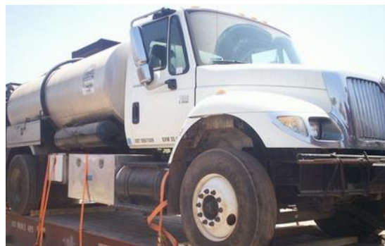
Gambar 5.13 Pengikatan Kendaraan 20 – 30 Ton
