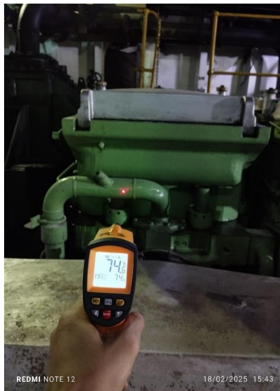
Lampiran 7 cek Temperatur pipa Fw outlet silinder no 8 setelah perawatan
