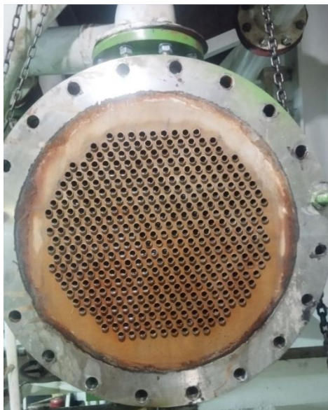
Gambar 4. 9 fresh water cooler setelah dibersihkan
