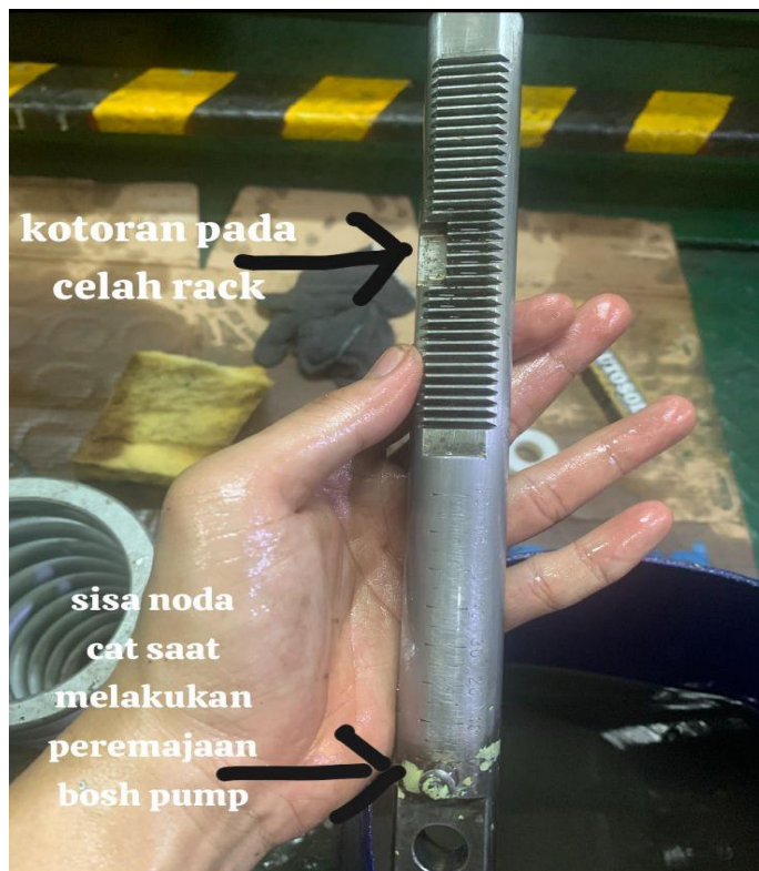
Gambar 4. 5 Penampang Rack yang Stuck
