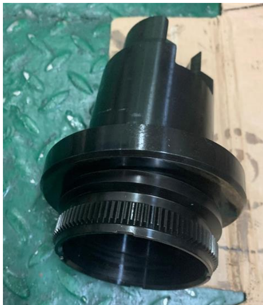
Gambar 4. 4 Control Sleeve yang Cacat
