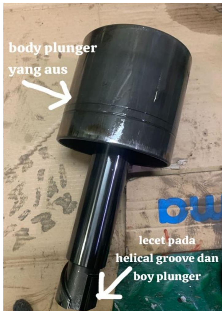
Gambar 4. 8 Penampang Plunger Fuel Injection Pump yang Aus
