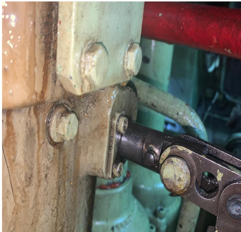
Gambar 4. 7 Penampang Rack yang Tidak Normal
