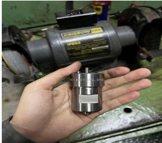
Gambar 4. 2 Nozzle injector yang baru
