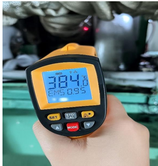
Gambar 4. 1 Temperatur gas buang yang melebihi batas normal
