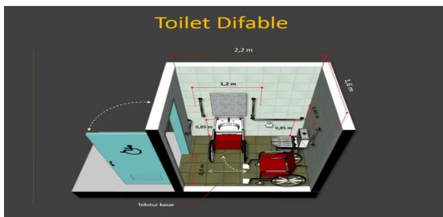
Gambar V.2 Toilet Ramah difabel
