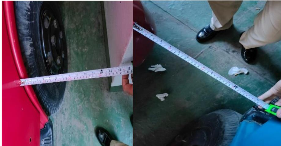
Gambar 1.3 Kondisi Jarak kendaraan sisi kiri kanan dan antar dinding kapal
