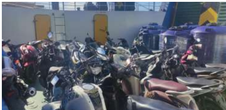
Gambar 4.22 Penempatan kendaraan yang melintang di atas kapal
