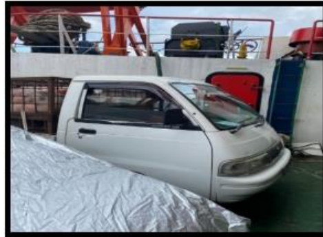
Kondisi Existing Penempatan Kendaraan Buritan Tanpa Lashing
