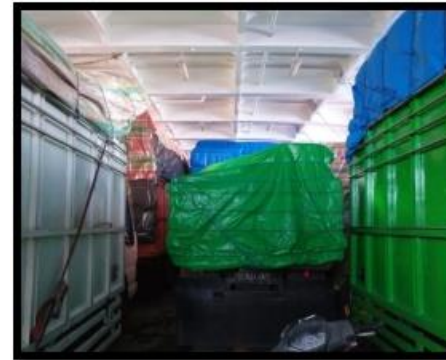
Kondisi Existing Penempatan Kendaraan Buritan Tanpa Lashing
