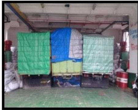
Kondisi Existing Penempatan Kendaraan Buritan Tanpa Lashing
