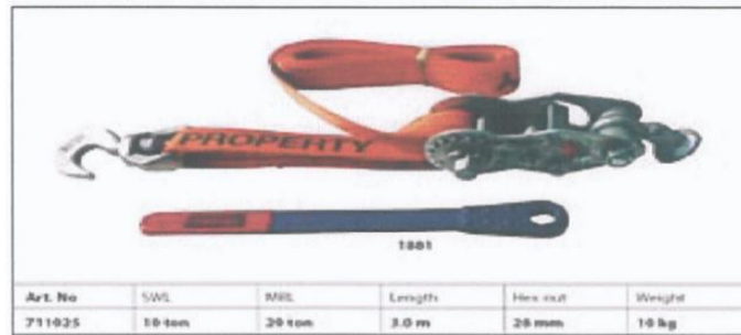
Gambar 2. 3 Sling Pengikat Dengan Kunci Bergigi ( Ratchet Strap Assembly ) Model Ganco Pada Satu Sisinya
