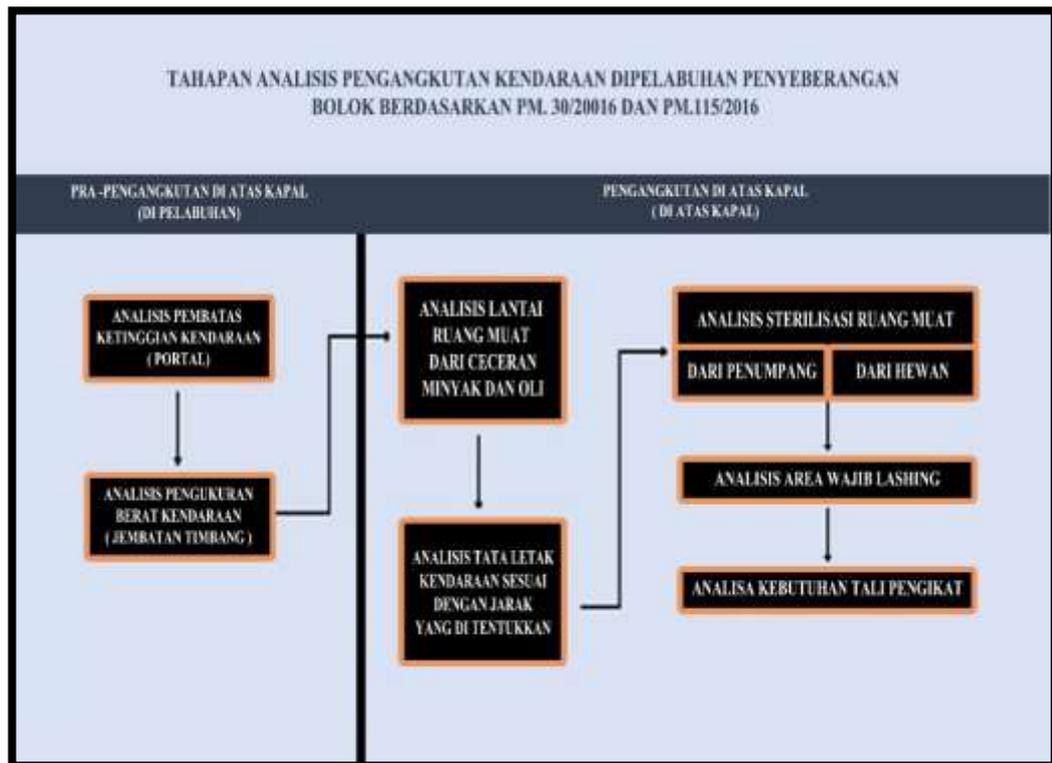
Gambar 3.1 Bagan Tahapan Analisis pengangkutan Kendaraan di Pelabuhan Penyeberangan Bolok
