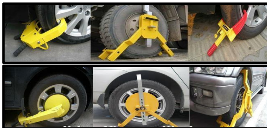
Gambar 2. 7 Jenis – Jenis Klem Roda Kendaraan Sumber: Peraturan Menteri Perhubungan Nomor 115 Tahun 2016
