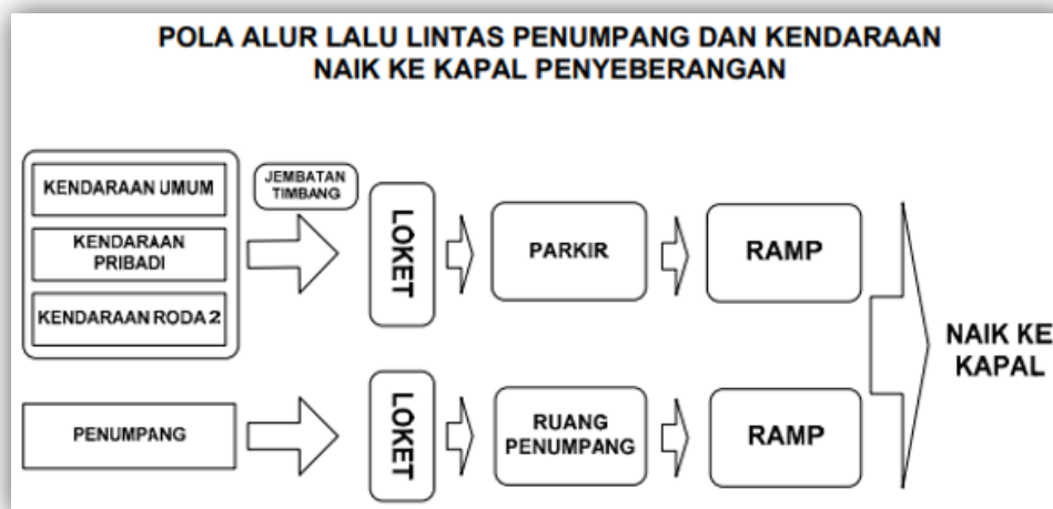
Gambar 2.1 Pola Arus Lalu Lintas Kendaraan dan Penumpang Naik Ke Kapal Sumber: Lampiran gambar pada SK. 242/HK.104/DRJD/2010
