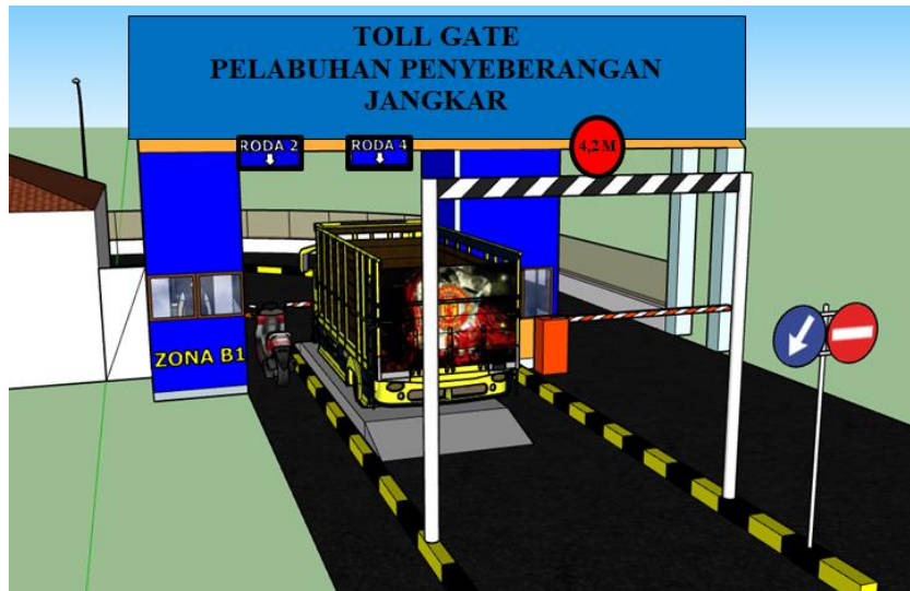
Gambar 4.39 Zona B1 (Jembatan Timbang dan Tollgate Rencana)
