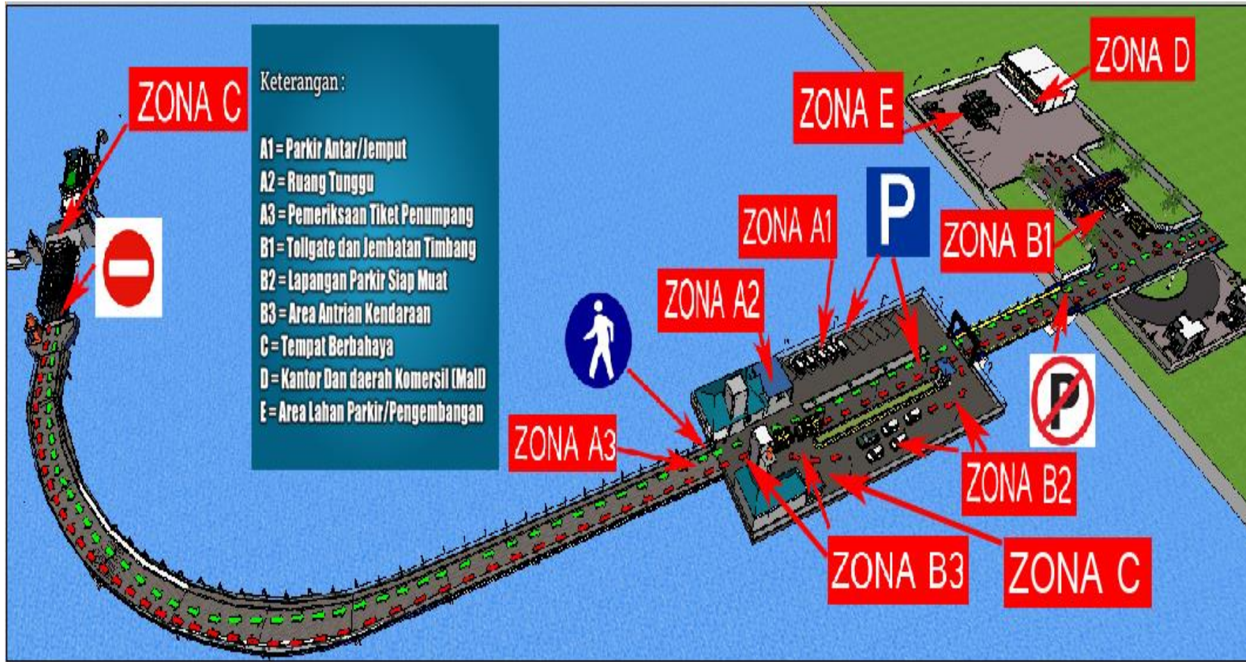
Gambar 4.52 Penempatan Rambu pada Pelabuhan Ro-ro
