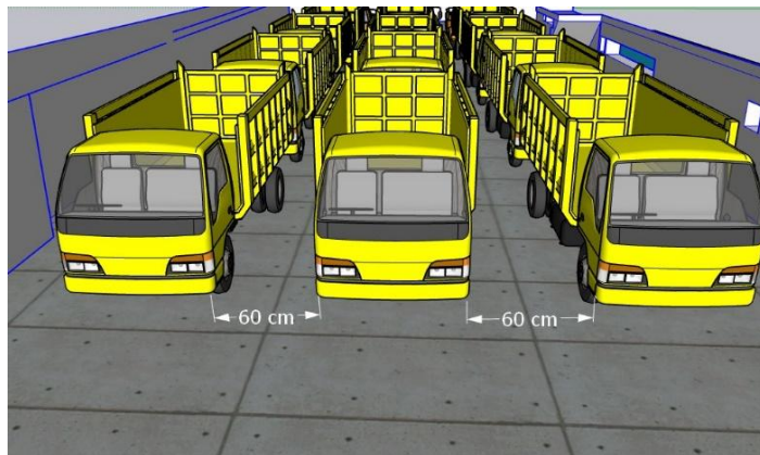
Gambar 4. 33 Jarak antar sisi kendaraan berdasarkan Permenhub Nomor 115 Tahun 2016
