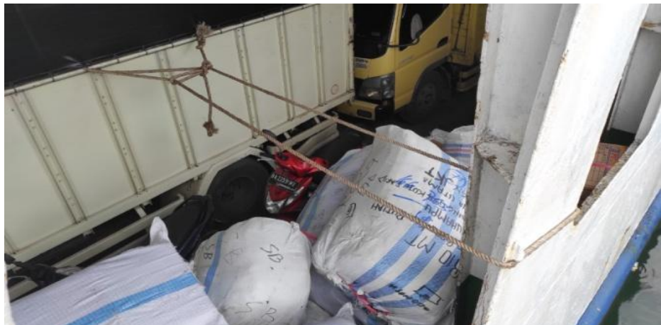
Gambar 4. 28 Kondisi Eksisting Lashing Kendaraan
