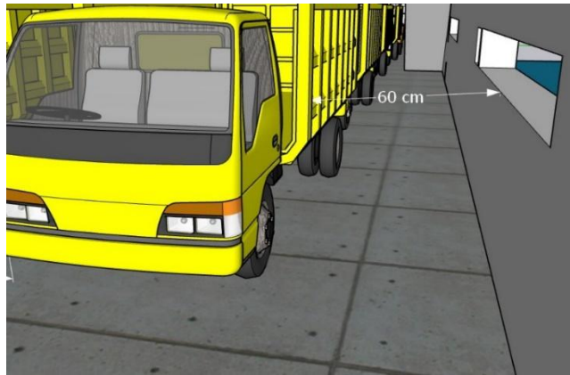
Gambar 4. 35 Jarak Kendaraan Ke Dinding Kapal Berdasarkan Permenhub Nomor 115 Tahun 2016
