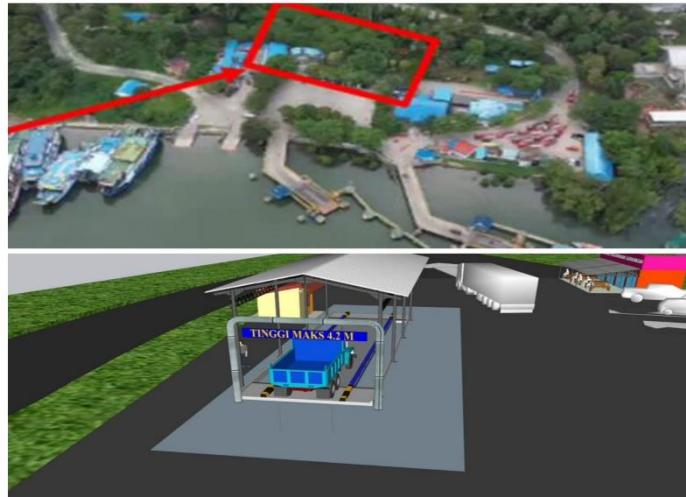
Gambar 4.29 Lay out Rencana Penempatan Jembatan Timbang dan Portal di Pelabuhan Penyeberangan Kariangau
