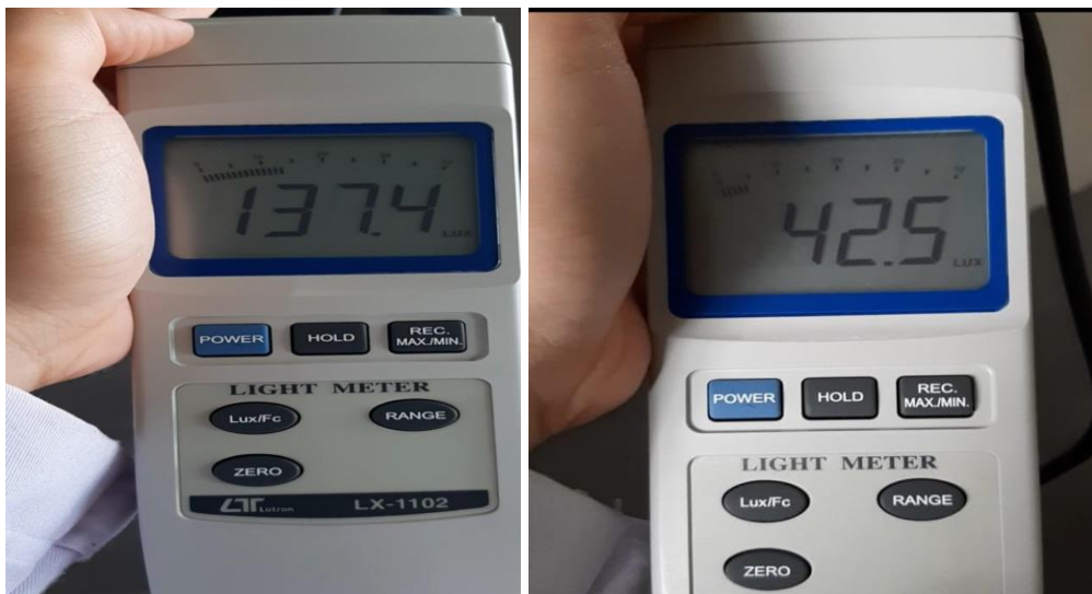
Gambar 4.28 Mengukur Intensitas Cahaya dengan alat Lux Meter
