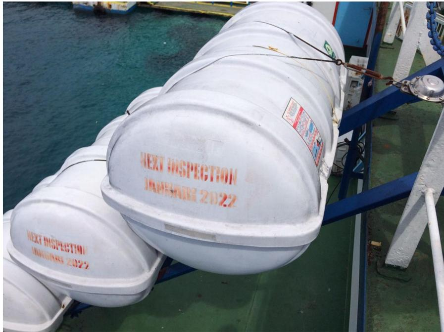
Gambar 4. 26 Kondisi Eksisting *Liferaft* pada KMP. Sardinela
