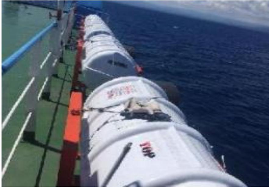
Gambar 4. 30 Kondisi Eksisting *Liferaft* pada KMP. Roka Tanjung Koako
