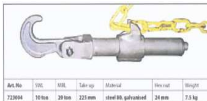
Gambar 2.4 Rantai Dengan Ganco (Rope Automobile Tiedown)
