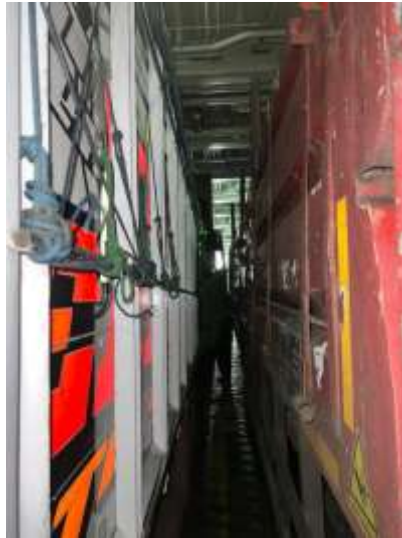
Gambar 4.24 Kendaraan Tidak Diikat
