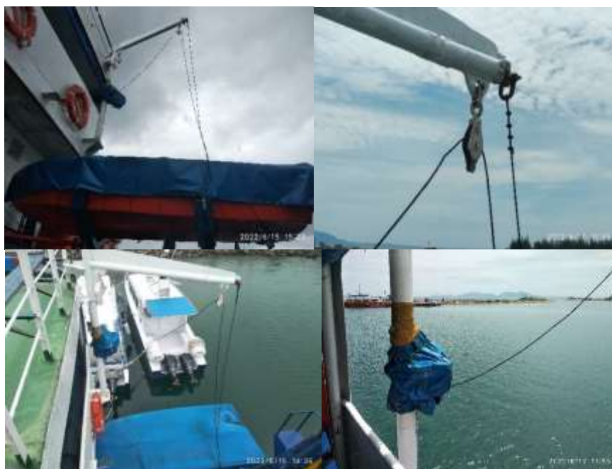
Gambar 4. 12 Kondisi eksisting sekoci penolong dan dewi-dewi sekoci pada KMP. Papuyu
