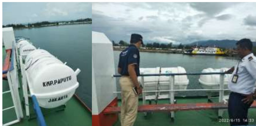
Gambar 4. 13 Kondisi eksisting rakit penolong pada KMP. Papuyu
