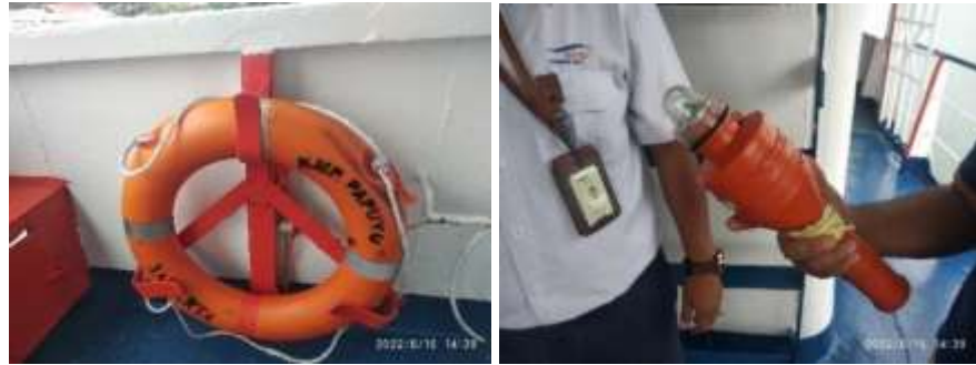
Gambar 4. 10 Kondisi eksisting pelampung penolong dengan lampunya pada KMP. Papuyu
