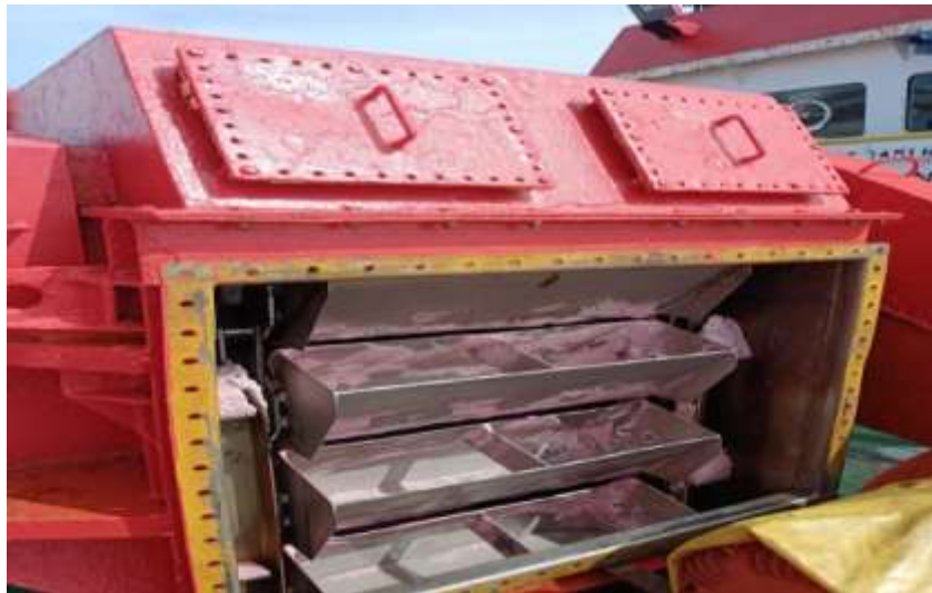
Gambar 2.6 Bucket elevator Sumber : Dokumentasi Pribadi, (2022).
