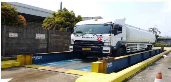
Gambar 2.8 jembatan Timbang Permanen
