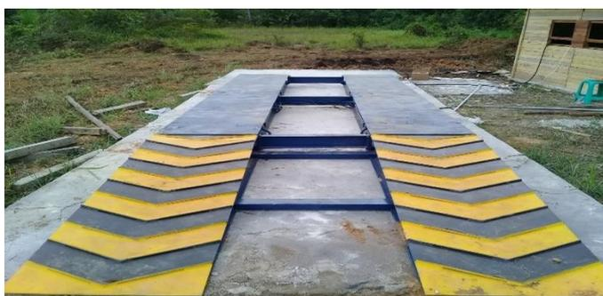
Gambar 2.9 Jembatan Timbang *Portable*
