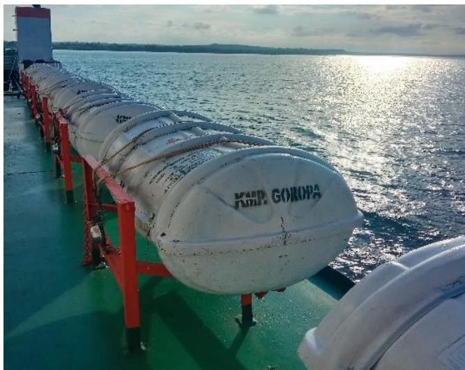
Gambar 4.32 Kondisi Eksisting Liferaft Pada KMP. Goropa
