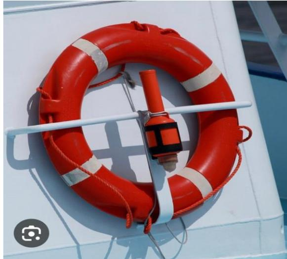
Gambar 4. 25 Contoh Pelampung penolong (*Lifebuoy*) dengan *self igniting light*
