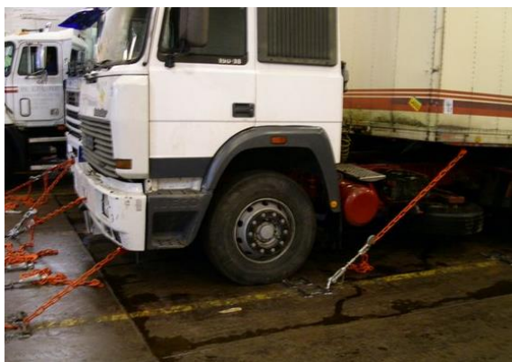
Gambar 5.9 Pengikatan Kendaraan 30 – 40 Ton
