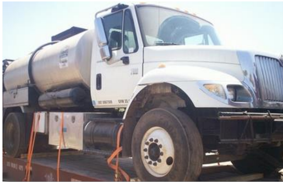
Gambar 5.8 Pengikatan Kendaraan 20 – 30 Ton
