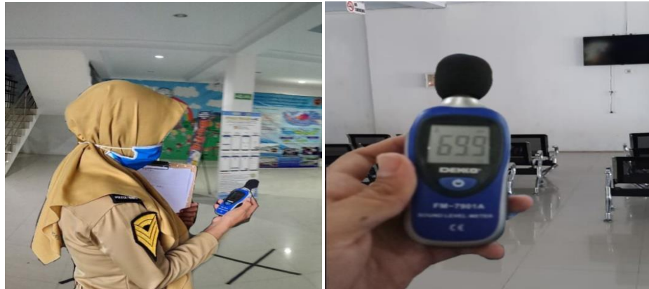
Gambar 5.11. Pengukuran intensitas suara di area terminal penumpang
