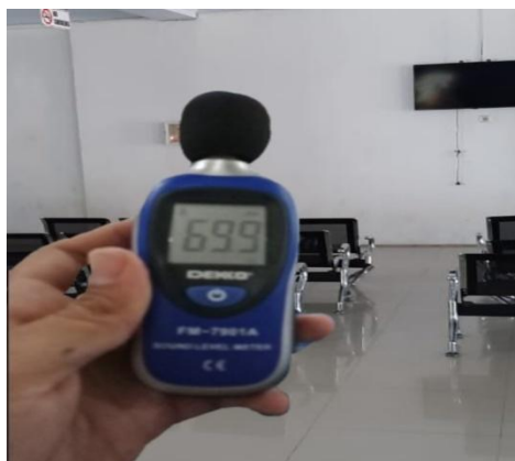
Gambar 5.11. Pengukuran intensitas suara di area terminal penumpang
