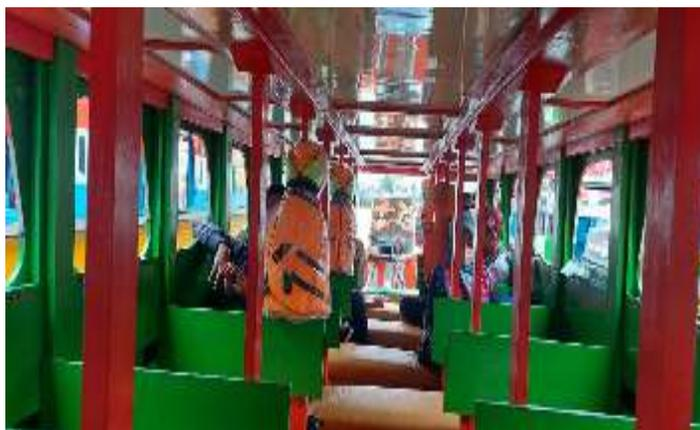
Gambar 8 Penempatan baju penolong dengan mengikat pada tiang kapal
