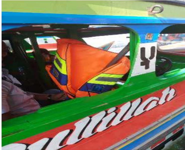
Gambar 5 Penempatan baju penolong pada tiang kapal
