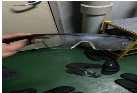
Gambar 4.5. Safety Glasses yang buram
