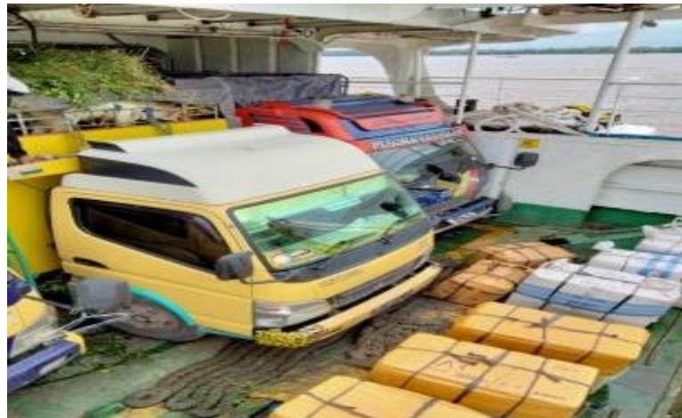
Gambar 4.7 Kendaraan yang berada di depan tidak di lakukan pengikatan
