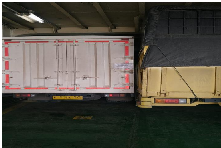
Gambar 4.8 Kendaraan yang berada di tengah tidak di lakukan pengikatan
