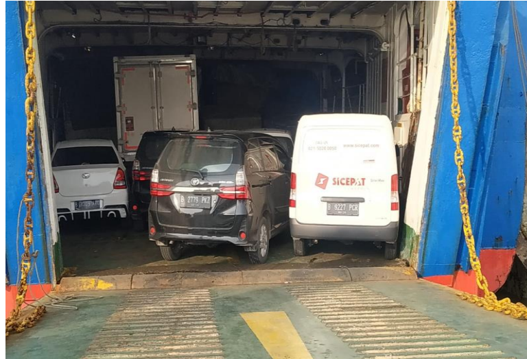
Gambar 4.9 Kendaraan yang berada di belakang tidak di lakukan pengikatan
