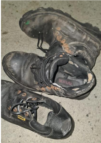
Kondisi Alat Pelindung Safety Shoes dan sarung tangan yang rusak
