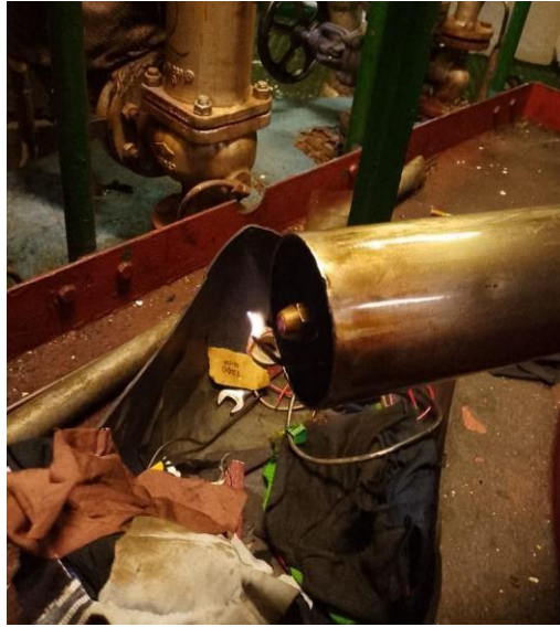
Gambar 4. 8 Cek Pembakaran Pada Nozzle Setelah Dibersihkan
