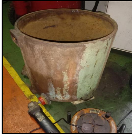
Gambar 4.9 Jacket cover yang mengalami korosi
