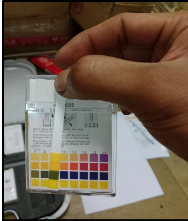
Gambar 4.14 Hasil pengujian sampel air pendingin.
