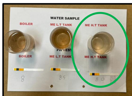
Gambar 4.13 Pengujian pada sampel air pendingin
