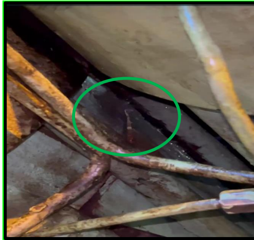
Gambar 4.6 Rembesan pada cover jacket cooling
