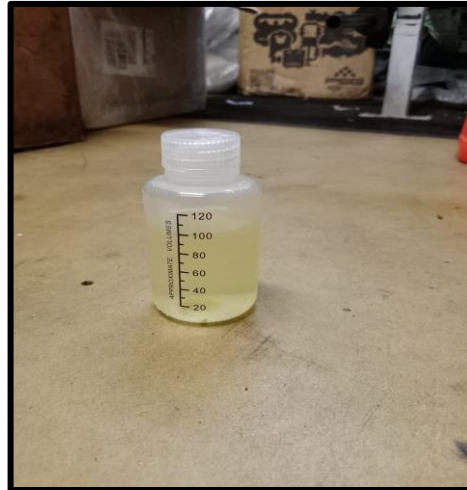
Gambar 4.12 Sampel air pendingin di tanki ekspansi
