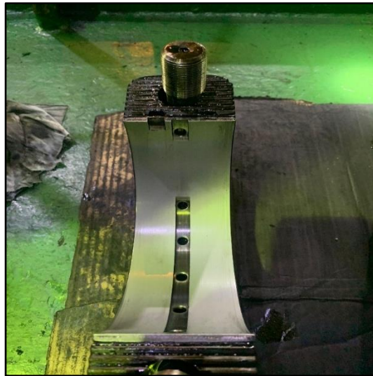
Gambar 4. 6 Crankpin Bearing Sumber : Dokumentasi Pribadi
