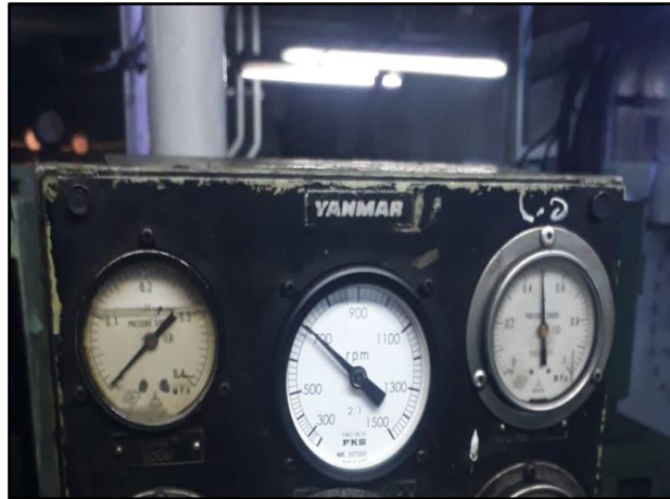
Gambar 4. 9 Tampilan Pressure Gauge pada mesin Diesel Generator Sumber : Dokumentasi Pribadi
