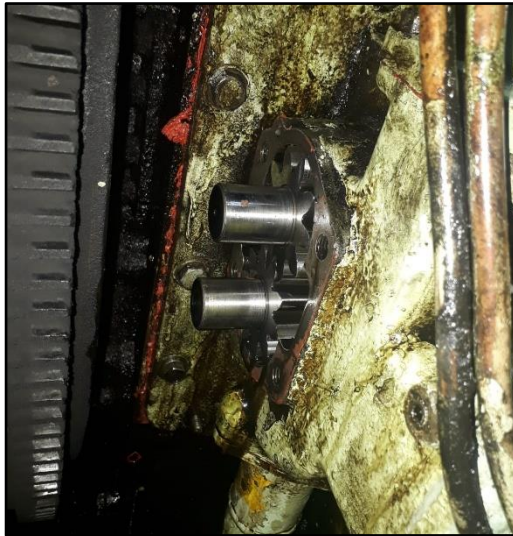
Gambar 4. 4 Kebocoran pada L.O Pump Sumber : Dokumentasi Pribadi
