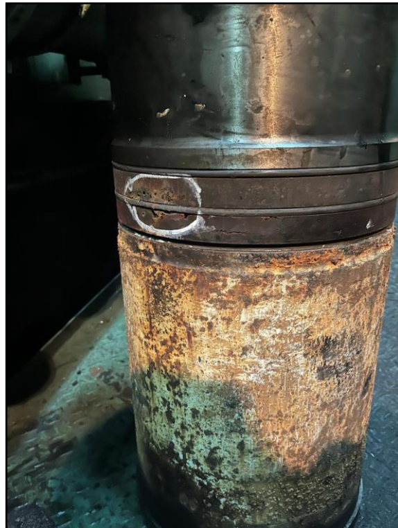
Gambar 4.4 Kerusakan O-Ring Liner
