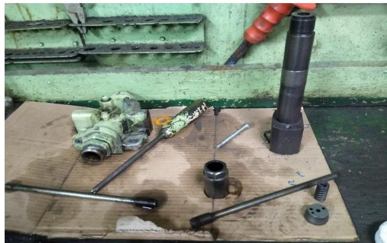
Gambar 4.5 Pengamatan komponen-komponen injektor
