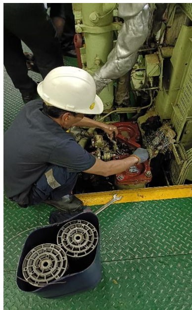
Gambar 4.5 sistem bahan bakar dan proses perawatan filter BB
