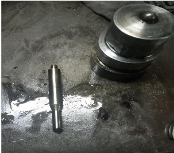
Gambar 4. 10 Pengecekan Pada Lubang Nozzle
