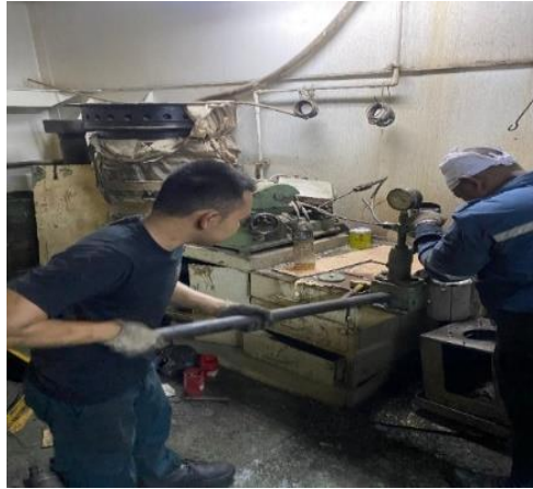
Gambar 4. 11 Test Injector dengan Injection Testing Pressure
