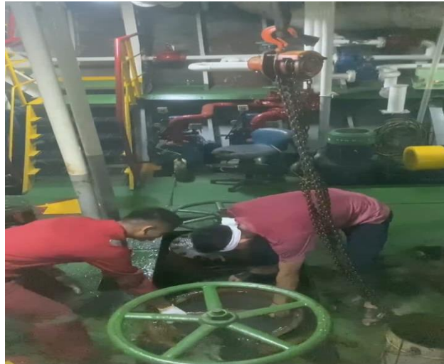
Gambar 4.8 Perawatan pada Sea Chest dan Filter Sea Chest
