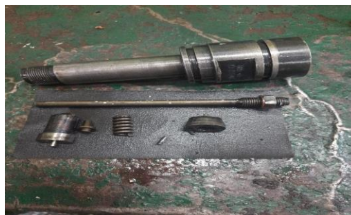
Gambar 4.20 Bagian – Bagian Injector 6DL 24
