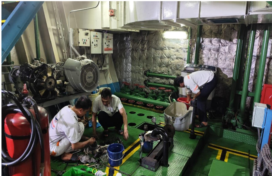
Gambar 4.3 Perawatan Kompresor Udara KMP.Sebuku
